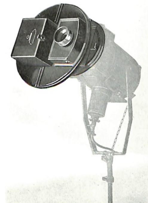
L'appareil à effets de nuages à carter circulaire, décrit à la page 26, ne peut être utilisé que pour projeter des nuages sur une toile de fond à surface relativement restreinte, par exemple une échappée sur le ciel à travers un décor de paysage.
