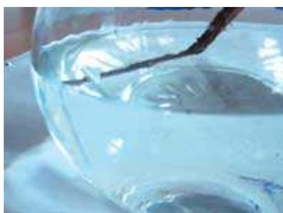
◄ Les rayons lumineux arrivant sur un bâton à moitié plongé dans l'eau ont une trajectoire différente dans l'eau que dans l'air. Le bâton apparaît déformé au niveau de l'eau.
